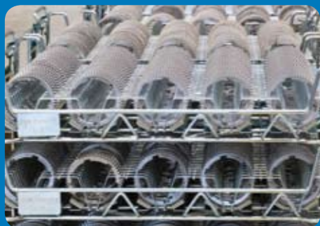
Sauber sortiert: Kupplungskörper für ein Fahrzeuggetriebe.
