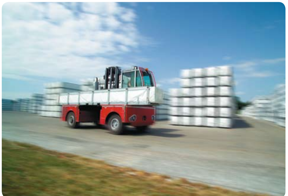
Die Seitenstapler bei der Salamander Industrie-Produkte GmbH sind mit noax-IPCs vom Typ C8 ausgerüstet.
