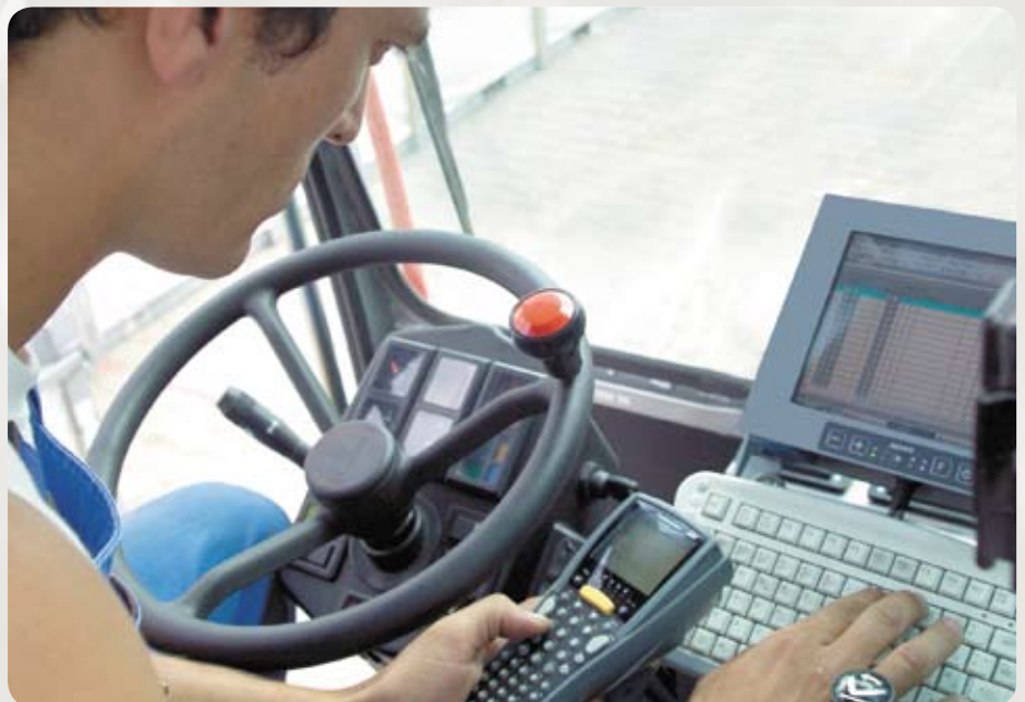
Alle Informationen im Blickfeld: Neben dem Lenkrad des Staplers befindet sich der IPC mit dem Lagerverwaltungssystem.
