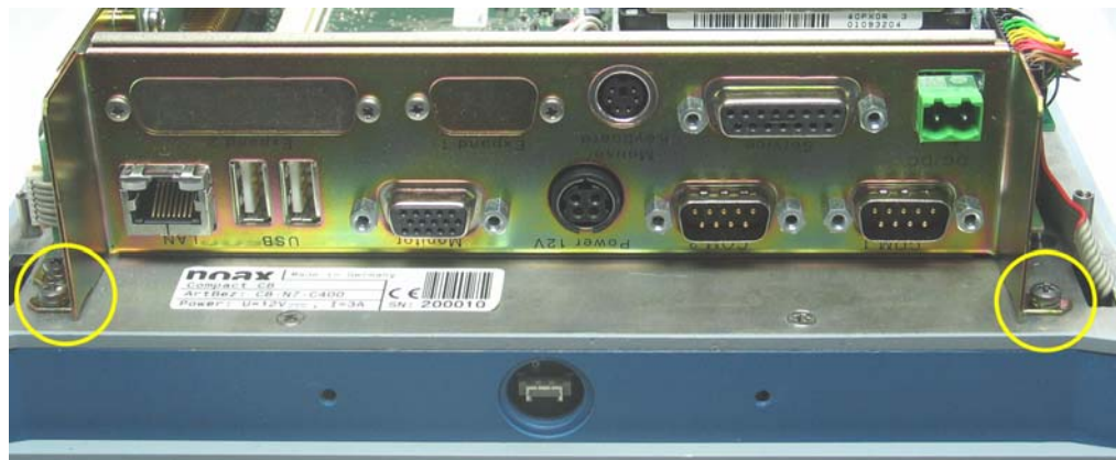
Abb. 5 Austauschen des Steckerbleches
