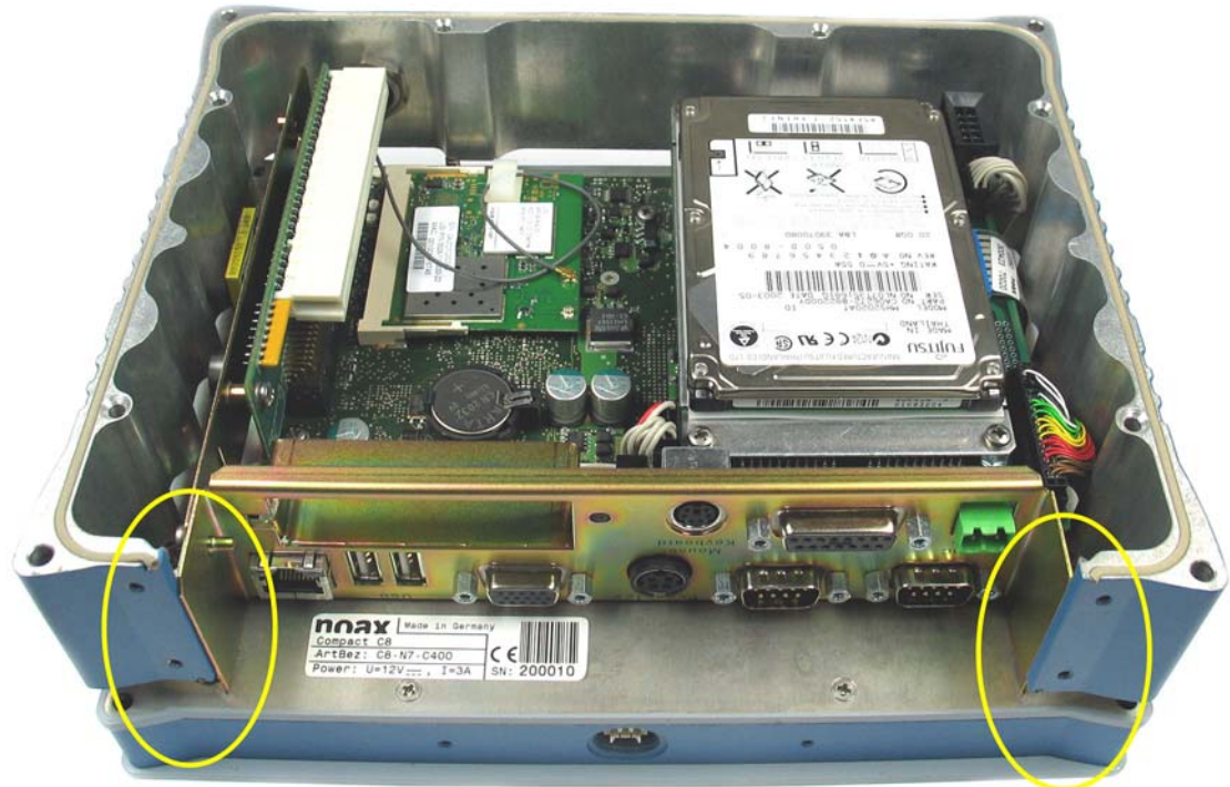
Abb. 10 Montieren des Elektronik-Ringes – 2. Schritt (bei Elektronik-Ring mit Antennenbefestigung)
