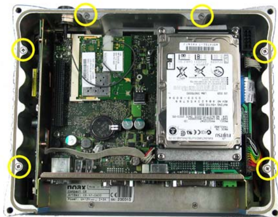
Abb. 4 Befestigungen des Elektronik-Ringes entfernen
