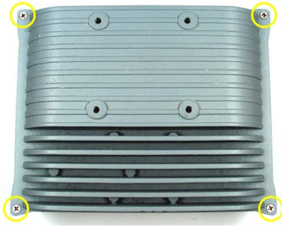
Abb. 3 Geräterückseite – Befestigung des Kühlkörpers
