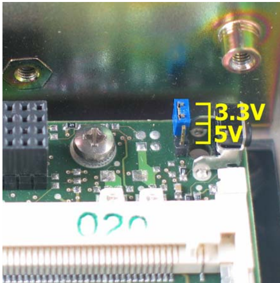
Abb. 1 Jumper X18 für Einstellung der Signalspannung
