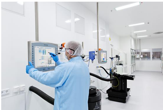
BU: Für eine flexible und ergonomische Arbeitsplatzgestaltung: noax Industrie-PC mit Tragarmsystem
